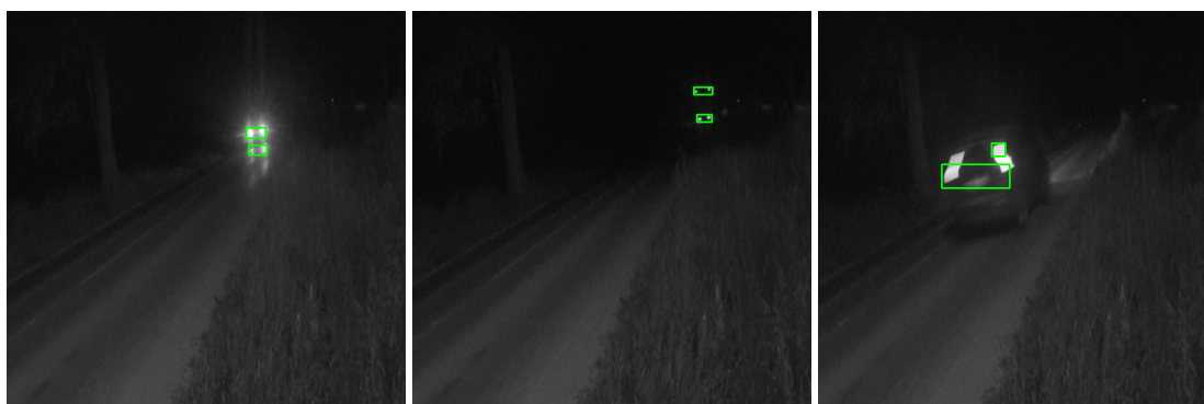
(a) Detekcja świateł pojazdu i odbić świateł na drodze (b) Wykrycie świateł tylnych ciężarówki na dole i na górze (c) Tył pojazdu znajdującego się blisko urządzenia rejestrującego
