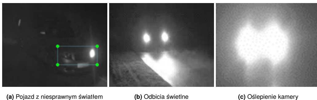
Rysunek 1.2: Obrazy z opracowanego zbioru danych - zaprezentowano przypadki trudne do detekcji dla algorytmów uczenia maszynowego
