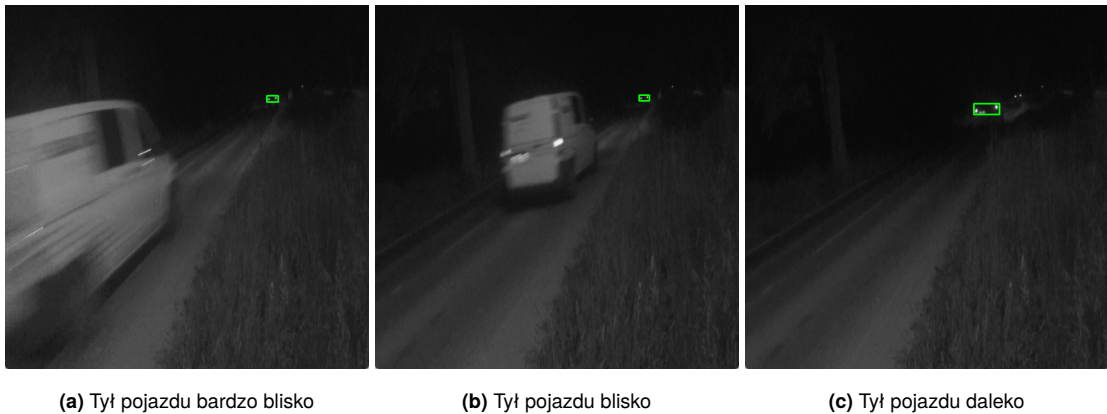
Rysunek 6.7: Wyniki detekcji tyłu pojazdu z zależności od odległości
